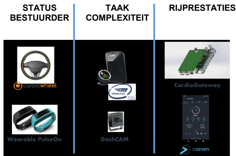
Figuur 1: Hardwarecomponenten om te monitoren in het voertuig
